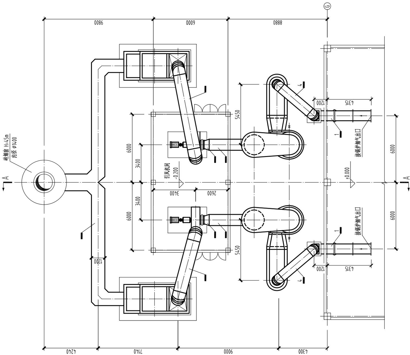
图 9 引风系统管道平面图画法示例
