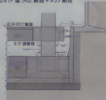
⑩ 下部基礎 CON → 免震装置取付
